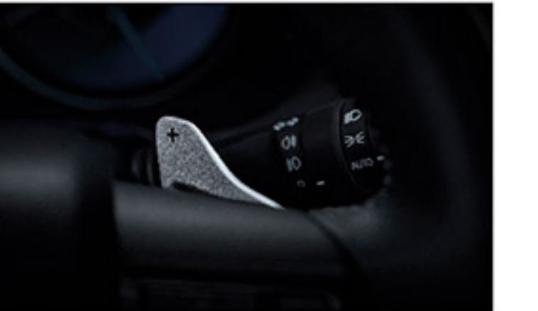
Paddle Shift ระบบควบคุม การเปลี่ยนเกียร์ที่พวงมาลัย เพิ่มความสะดวกในการขับขี่
