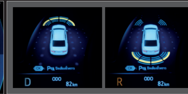
PARKING SENSOR สัญญาณเตือนกะระยะ: 8 ตำแหน่ง
