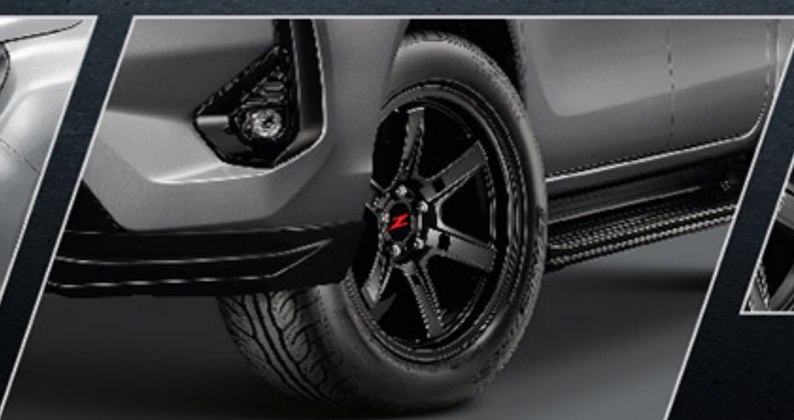
ล้ออัลลอย ดีไซน์ Exclusive ขนาด 18 x 18.5 ET 10 ยาง LENSU ขนาด 255 / 50 R18 จัดทรงด้วยชุดความสูงรถ แบบรองแน่นแหมบ ขนาด 30 มม.
